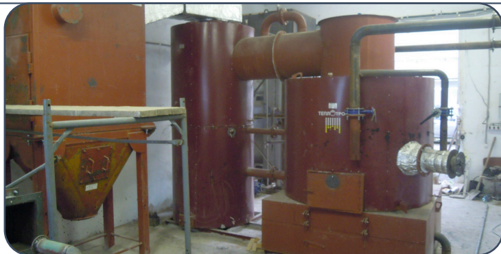
Пилотная установка по очистке дымовых газов тепловых электростанций угольной генерации от оксидов серы и азота (участок сжигания угольного топлива), построенная российским партнером
